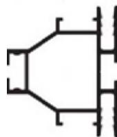
Le cadre à toile de tension ALU-tf 46 plus large peut être utilisé pour créer des cadres plus grands et autonomes qui conviennent également aux cloisons de séparation. Les traverses internes donnent la stabilité nécessaire au cadre plus large. Différents pieds transversaux ou plaques de sol sont disponibles en option.
