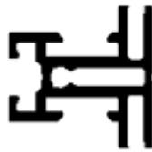
Le cadre à toile de tension ALU-tf 33 est le cadre le plus étroit pouvant être utilisé des deux côtés. Cela peut être utilisé pour les petits présentoirs ou pour les plaques suspendues. Des pieds transversaux en aluminium ou des systèmes de câbles sont également disponibles.
