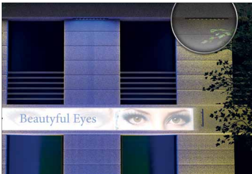
Fassadenbeleuchtung mit farbigen LED's für Lichteffekte an der Fassade, weisse LED's für Schildbeleuchtung.
